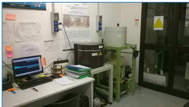
Una tecnica analitica permette la rilevazione sia di eventi alfa che di eventi beta; tale tecnica è la scintillazione liquida, che grazie a non complesse tecniche preparatorie del campione consente di poter determinare tutti i parametri di screening iniziale richiesti dalle norme e linee guida sopra richiamate, **Trizio, Radon e attività alfa totale e beta totale.**
