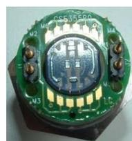
1. Saldatura laser dell'elemento sensibile al puntale
